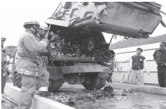
写真2 圧縮する際に火災が発生したパッカー車
